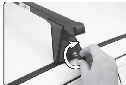
Nasaďte kryt a uzamkněte patku nosiče otočným klíčem.
