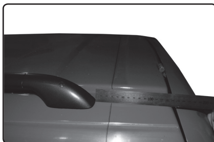
Zadní patku umístěte 30 mm od spoje plechů střechy vozu.
