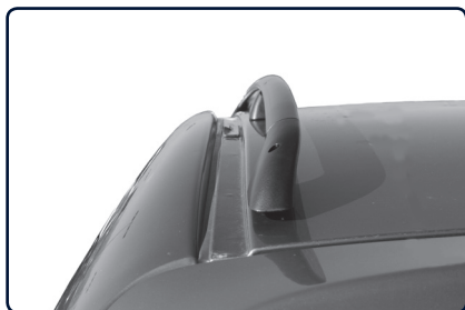
Podélný střešní nosič se instaluje na vnitřní stranu od prolisu střechy vozu.
