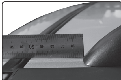
Zadní patku umístěte 120 mm od vnitřní hrany gumy zadních dvoukřídlových dveří. Je-li vůz vybaven jednokřídlovými dveřmi, umístěte patku 120 mm od zadní hrany střechy vozu.
